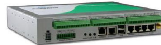
SB 450 télégestion passive, active et réactive
